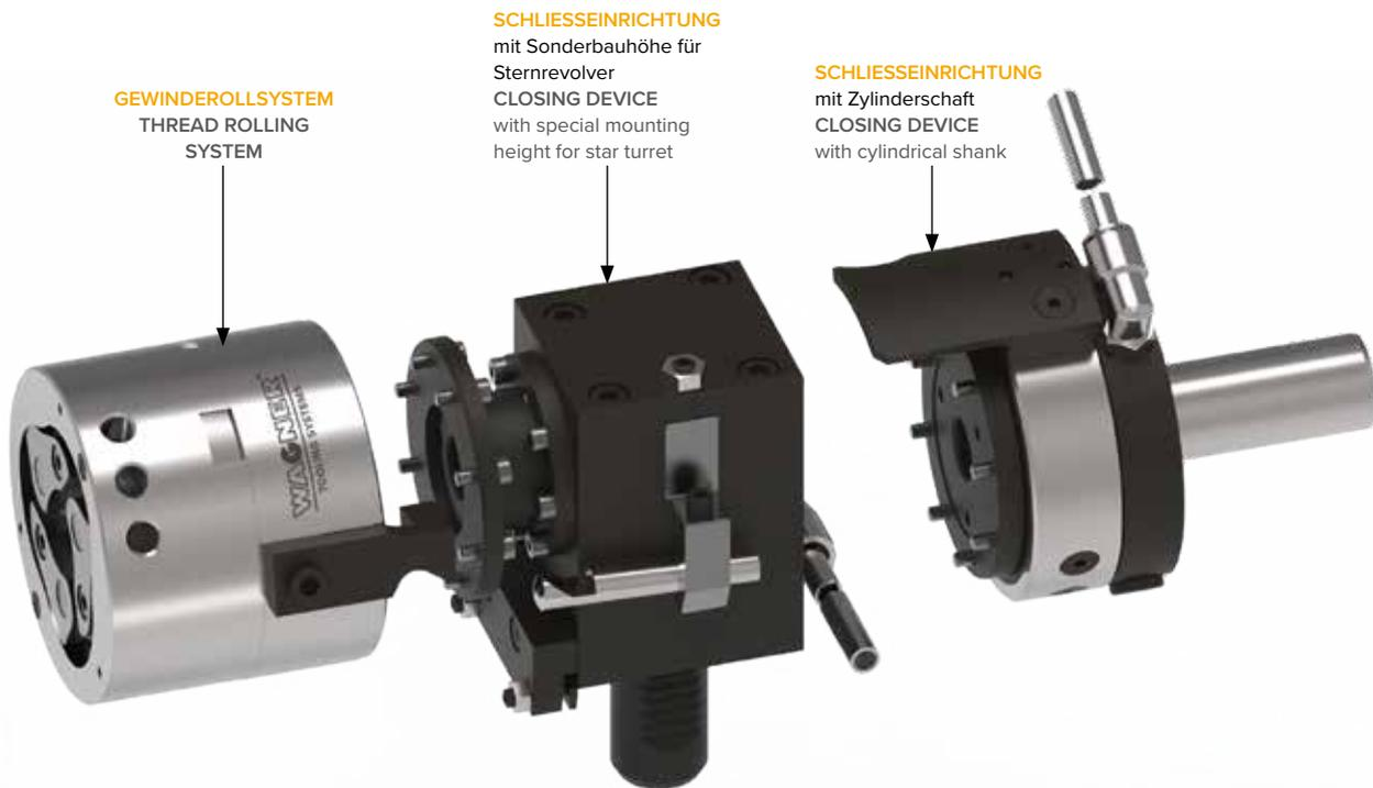
Zu einer Reduzierung der Taktzeiten werden bei Axial-Rollsystemen Schließeinrichtungen verwendet. Diese haben die Aufgabe, das im Prozess sich automatisch öffnende Werkzeug wieder zu schließen. Idealerweise erfolgt das Schließen in der Nebenzeit. Da das nicht immer möglich ist, hat das Unternehmen Wagner die Schließzeit seiner Werkzeuge auf weniger als 0,2 Sekunden reduziert.
